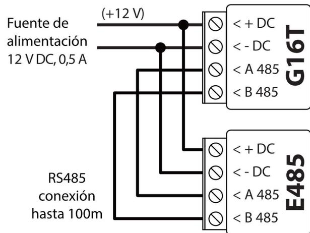
**Inserte tarjeta SIM en el comunicador G16 (G16T) para que funcione con el E485.**
