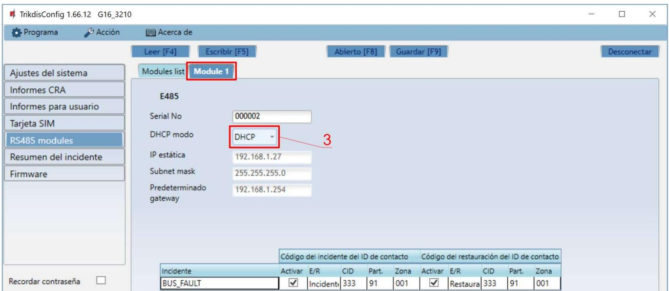
3. Seleccione el modo **DHCP**: **DHCP** y el **módulo E485** escaneará automáticamente la configuración de red. (**Gateway, máscara de subred, IP estática**).
