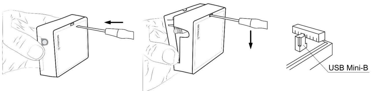
3. Con un cable USB Mini-B, conecte el **G16 (G16T)** a la computadora.
