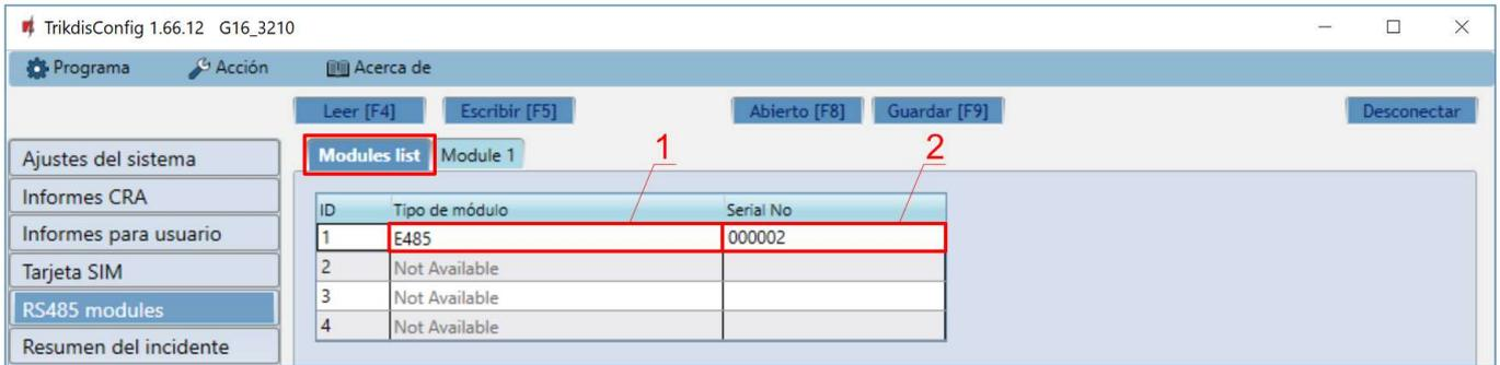
1. **Tipo de Módulo**– seleccione el módulo (**E485**) que está conectado al comunicador a través de RS485 de la lista.
