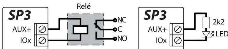
Usando las terminales de relé es posible controlar (encender/apagar) de forma remota varios dispositivos eléctricos. El terminal I/O universal del panel debe configurarse como una salida (OUT) y debe tener asignada la definición de **Control remoto**.
