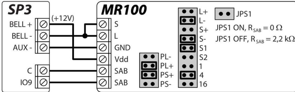
El diagrama muestra la conexión y la configuración de la sirena exterior **MR100**. Si el panel de control utilizará un método diferente para monitorear la EOL (la configuración de fábrica es 2.2 kOhm EOL) del circuito de sabotaje de sirena (terminales SAB), es necesario cerrar los contactos JPS1 y conectar una resistencia de la clasificación correspondiente en serie a El circuito de sabotaje. El tipo de zona de **24\_horas** está configurado de fábrica para la entrada IO9.
