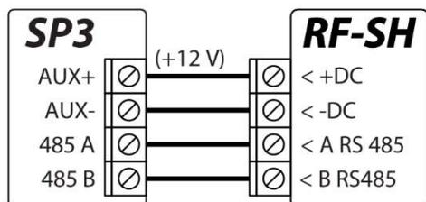
Con el **RF-SH** es posible conectar 64 controles remotos inalámbricos, 16 sirenas inalámbricas, 32 sensores inalámbricos y 8 teclados inalámbricos al sistema de seguridad.
