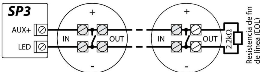
Diagramas de cableado para detectores de humo de dos hilos con módulo de relé SM1. Para conectar un circuito detector de humo a una entrada (IOx), la entrada debe tener asignada la función **Zona de incendio** (consulta el capítulo 5.7 Ventana "Zonas").
