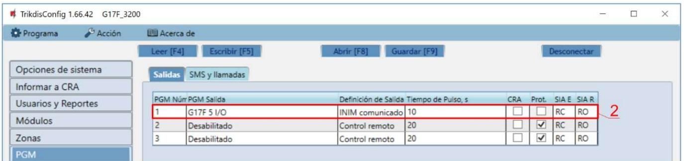
2. Especifique la salida PGM del comunicador **G17F** que está conectada al terminal 19 (+Dialer) del panel de control de incendios. Establezca "Definición de salida – Comunicador Inim". (La salida PGM se enciende cuando el comunicador **G17F** tiene problemas para conectarse al CRA o no puede enviar mensajes. El indicador "Disable/Fault Dialler" se enciende en el panel de control de incendios y se enciende una señal de sonido).
