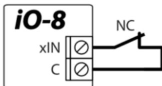
Circuito normalmente cerrado/abierto con resistencia de fin de línea (EOL)
