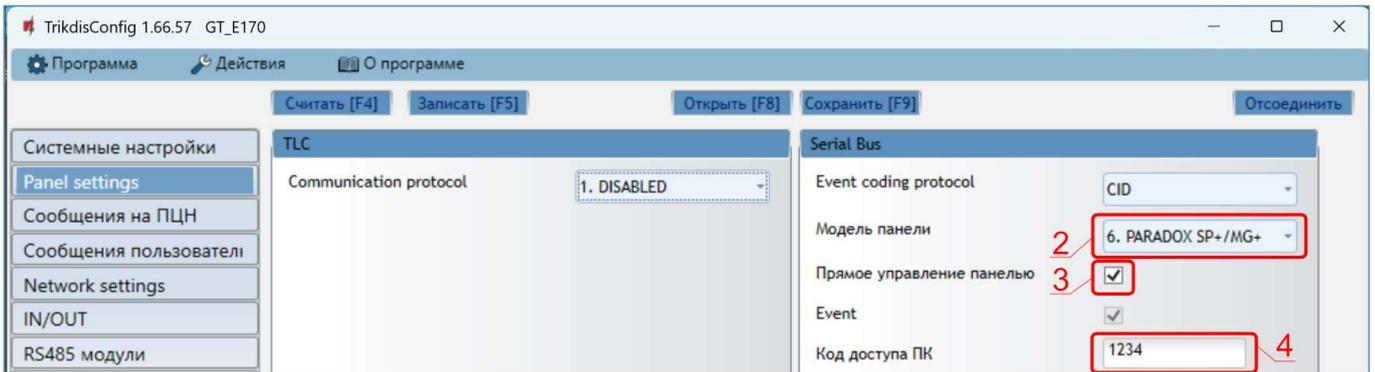
2. Если коммуникатор подключен к шине клавиатуры или последовательной шине охранной панели, то выберите модель охранной панели, которая будет подключена к коммуникатору.
