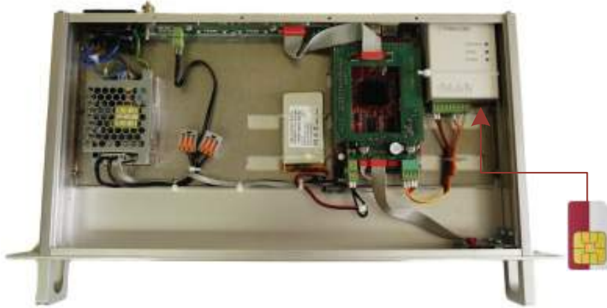
Вид приёмника со снятой верхней крышкой
