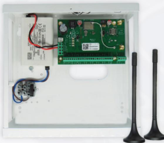
Centralės **FLEXi SP3 plokštė**, įmontuota į metalinį korpusą (200 x 210 x 80 mm)
