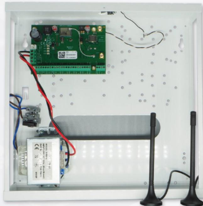
Centralės **FLEXi SP3 plokštė**, įmontuota į metalinį korpusą (285 x 280 x 80 mm)
